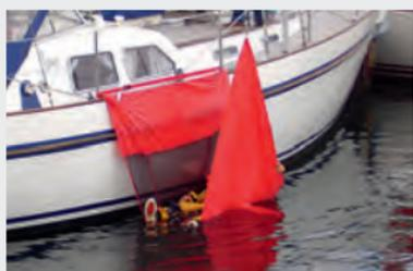
Jetzt kann die Person mit Hilfe der Fallwinde an Bord gebracht werden.
