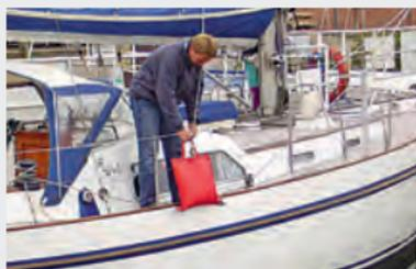
Ein Fall am Kopf des Bergesegels befestigen. Die Befestigungsgurte um die Relingstützen legen und festziehen.
